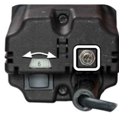
Interfejs fotowoltaiczny i koło ustawień MM-1000DI i MM-1650DI
